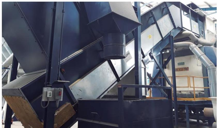
que aporta en todos los equipos instalados. El sistema de separación mediante presión negativa que generan los equipos NIHOT en la cámara de expansión, marca la diferencia respecto al resto de competidores.
