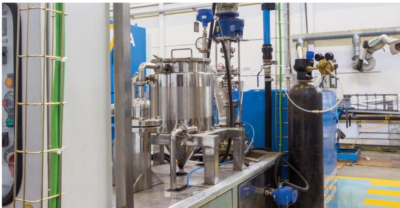
Figura 5. Planta piloto de pirólisis de AIMPLAS
