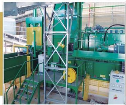
**PRENSA DE TÚNEL CERRADO CON ATADO DE FLEJE Y ENVOLVEDOR DE BALAS**
