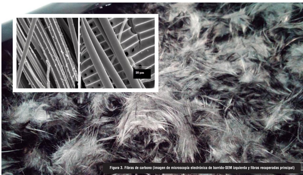
Figura 3. Fibras de carbono (imagen de microscopía electrónica de barrido-SEM izquierda y fibras recuperadas principal)
